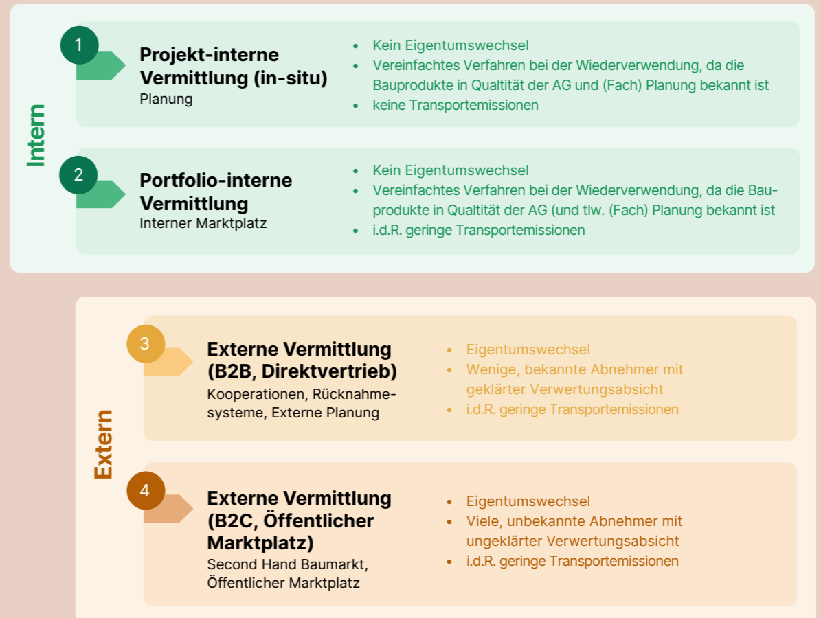
Abbildung 5.3: Hierarchie der Wiederverwendung von Bauprodukten mit zusätzlichen Vorteilen
